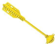
La Suspente Intégra<sub>2</sub> Réglable permet de fixer la membrane Vario® Xtra entre l'isolant et la fourrure, pour une gestion de la vapeur d'eau et une étanchéité à l'air parfaite des combles aménagés. Elle est adaptable à tous types de charpente, réglable sans outil et entièrement démontable.
